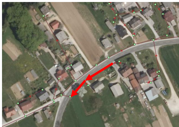
Intervencijska sanacija kanalizacije Ratež; menjava cevi DN200
